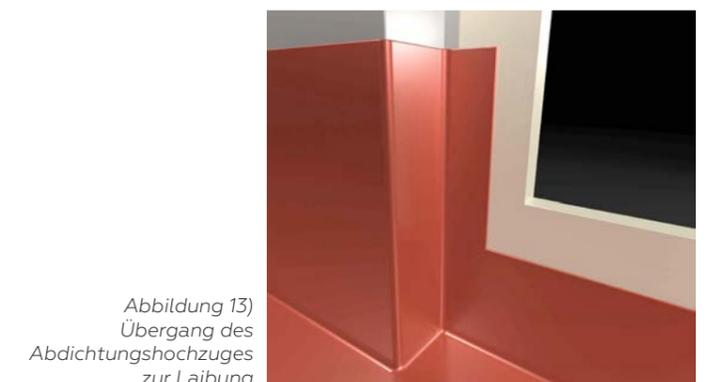
Abbildung 13) Übergang des Abdichtungshochzuges zur Laibung
