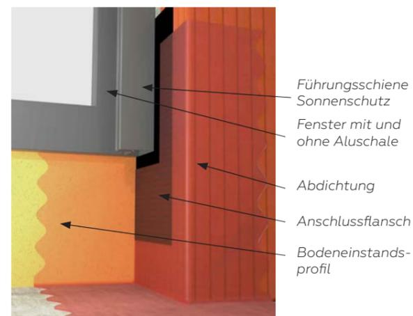
Abbildung 21) Prinzipskizze Fenster mit Sonnenschutzführungsschiene, Anschlussflansch und Abdichtung
